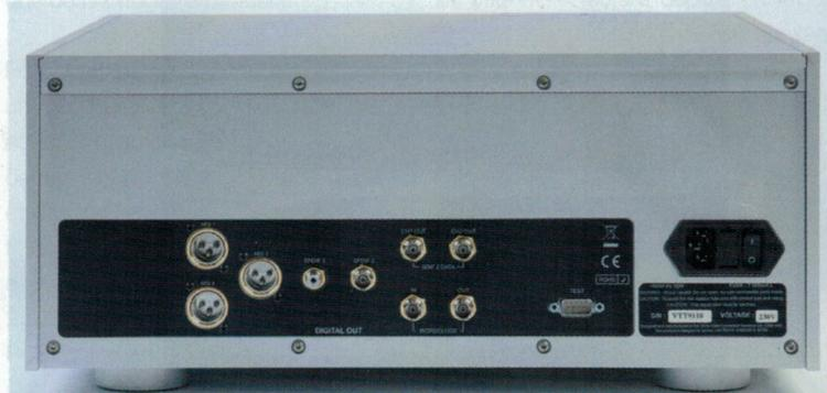
*Le transport dispose d'une double sortie AES qui supporte le DSD (1 bit à 2.822 MS/s) vers un DAC dCS depuis un CD ou SACD.*
