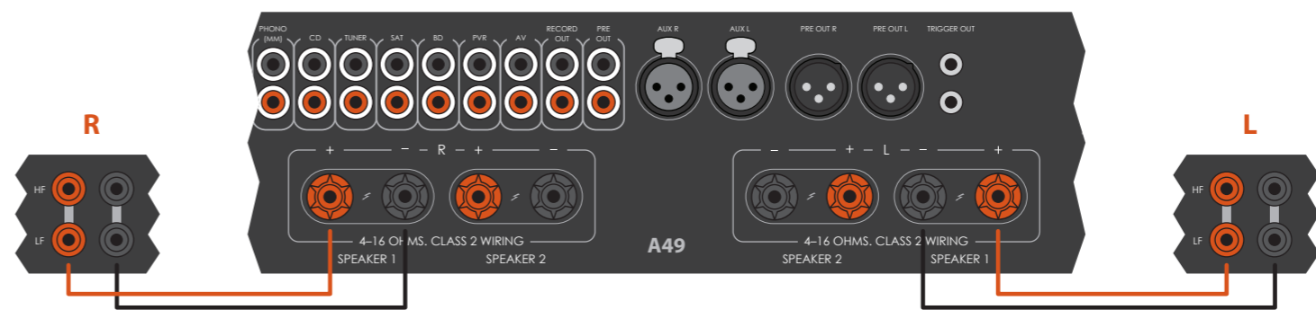
Un A49 branché aux haut-parleurs à l'aide d'un câblage simple.
