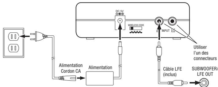
1. Branchez le câble LFE fourni entre la sortie de caisson de graves de votre processeur ou récepteur et l'un des connecteurs d'entrée de l'émetteur.
