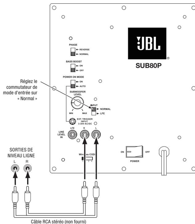
Utilisez cette méthode d'installation pour les récepteurs et préamplificateurs/processeurs qui n'ont pas de sortie de caisson de graves dédiée, mais qui disposent de sorties ligne de niveau préamplificateur (commandées en volume).
