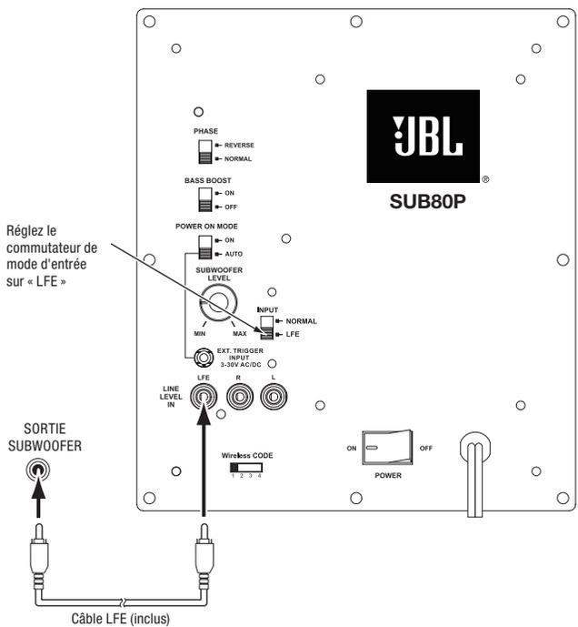
Utilisez cette méthode d'installation pour les récepteurs et les préamplificateurs/ processeurs qui disposent d'une sortie de caisson de graves dédié.
