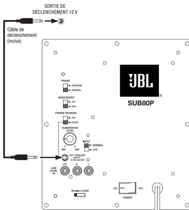
Le caisson de graves s'allume automatiquement s'il reçoit une tension de déclenchement sur son connecteur d'entrée de déclenchement externe et se met en veille lorsque la tension devient nulle.
