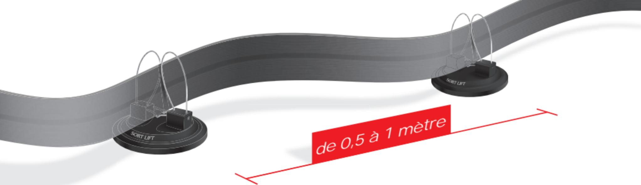
Les supports Sort Lift® doivent être placés de telle sorte que le câble soit complètement isolé du sol. La distance dépend du poids et de la souplesse du câble maintenu.
