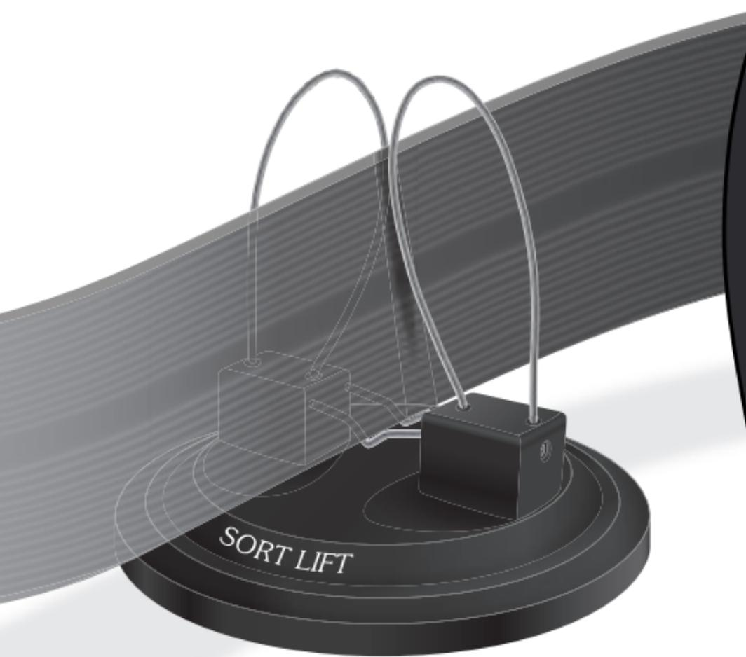
Placez les câbles plats pour enceintes comme indiqué entre les ailes de maintien, en les reposant dans le creux du support de tension.
